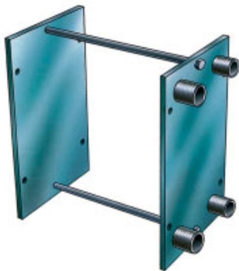
1. Рама теплообменника в собранном виде. Она состоит из опорной и прижимной плит, верхней и нижней несущих балок и патрубков.
