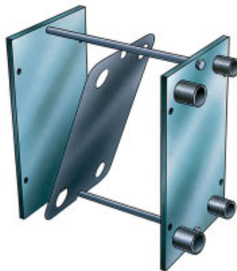
2. Первой устанавливается на раме концевая теплообменная пластина.
